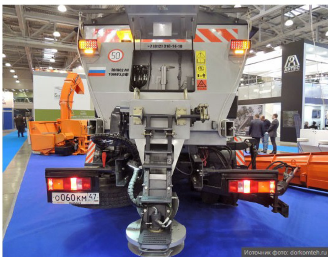
Распределитель реагентов "Урсус" изготовлен из нержавеющей стали
