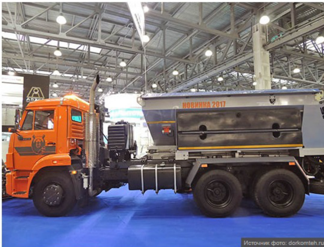
МКДУ-1 с фронтальным скоростным и боковым отвалами может очищать полосу 6-метровой ширины
