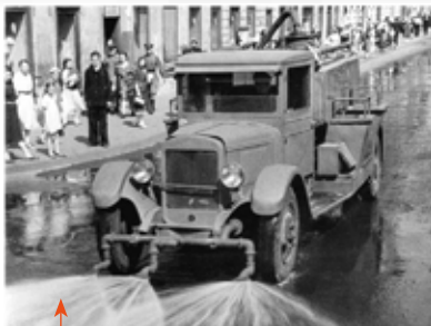
Мойка покрытия машинами с щелевыми насадками
