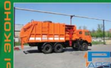
Традиционный мусоровоз с боковой загрузкой + для контейнеров пластиковых 0,12 – 1,1 м 3 , стандартных 0,75 м 3 и 0,8 м 3 – оцинкованных 0,77 – 1,1 м 3 + мусоровоз может комплектоваться краном манипулятором.
