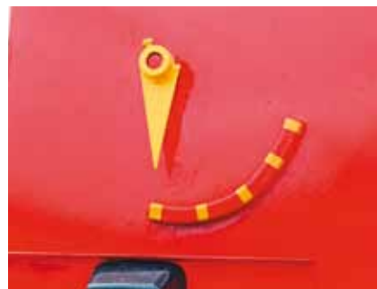
Поплавковый датчик уровня с градуированной шкалой хорошо различим
