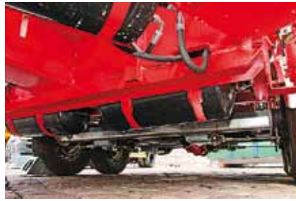
Ресиверы тормозной системы закреплены снизу силовой конструкции
