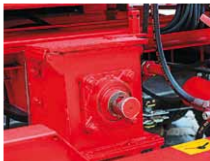
Узел фирменного шнекового механизма подачи щебня
