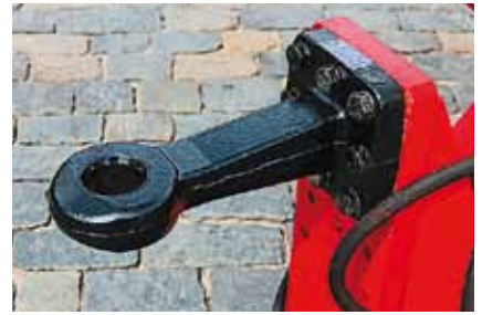
Положение сцепного устройства можно менять. Крепление болтовое
