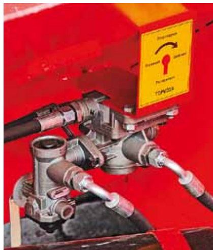
Управляющий элемент пневматической системы
