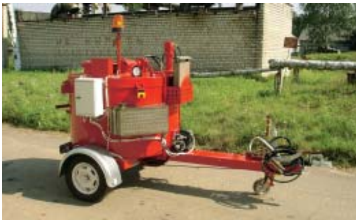
Мастичный котел с приводом от внешнего источника питания (380V) ЭД-35М (с масляной рубашкой)
