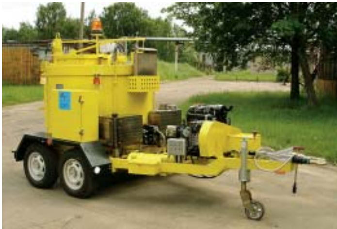
Мастичный котел с приводом от автономного двигателя серия ЭД-135М (с масляной рубашкой)
