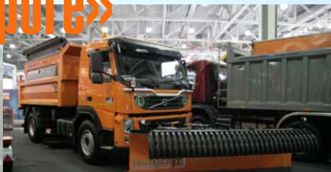
Универсальная дорожная машина с распределителем реагентов Epoke Sirius AST компании «Коминвест-АКМТ»
