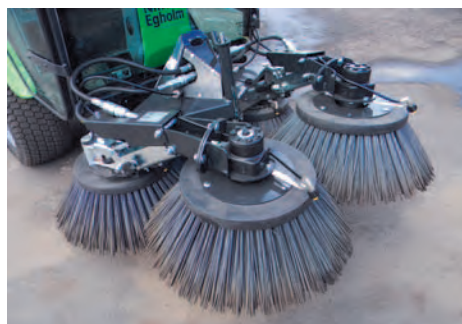
Многофункциональные щетки варьируют ширину очищаемой поверхности и могут работать не только в горизонтальной плоскости, но и в вертикальной
