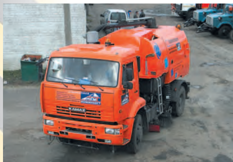
Вакуумно-подметально-уборочная машина Johnston предназначена для содержания в надлежащем состоянии городских улиц и площадей в весенне-летний период
