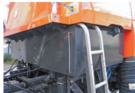
Уборочная машина Johnston приводится в движение автономным двигателем Iveco, у которого даже есть свой топливный бак и отличная шумоизоляция
