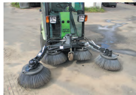
Многофункциональные щетки варьируют ширину очищаемой поверхности и могут работать не только в горизонтальной плоскости, но и в вертикальной
