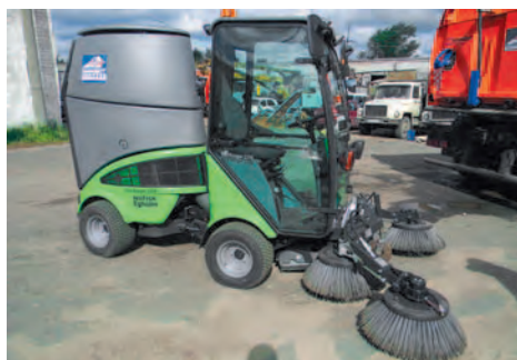
Компактная и маневренная вакуумно-подметально-уборочная машина Nilfisk Egholm City Ranger 2250 предназначена для уборки тротуаров, площадей, дворовых и прочих территорий с затрудненными условиями для маневрирования
