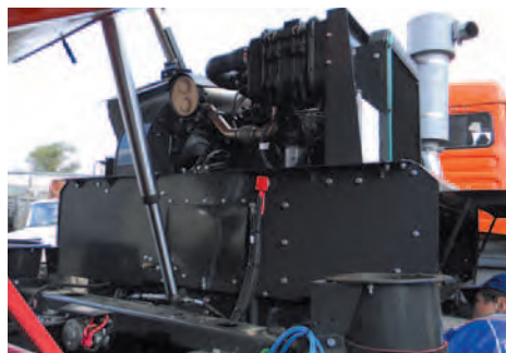
Уборочная машина Johnston приводится в движение автономным двигателем Iveco, у которого даже есть свой топливный бак и отличная шумоизоляция
