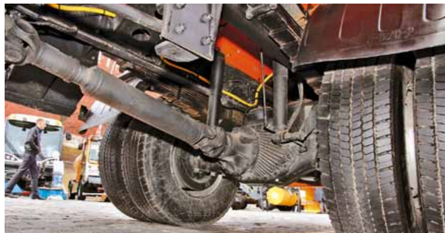
Ведущий мост производства немецкой компании MAN имеет блокировку дифференциала, повышающую проходимость машины
