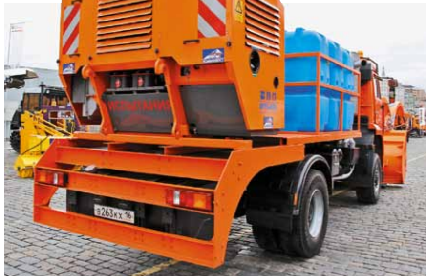
Автономный двигатель привода рабочего и вспомогательного оборудования монтируется на задней части рамы автомобильного шасси
