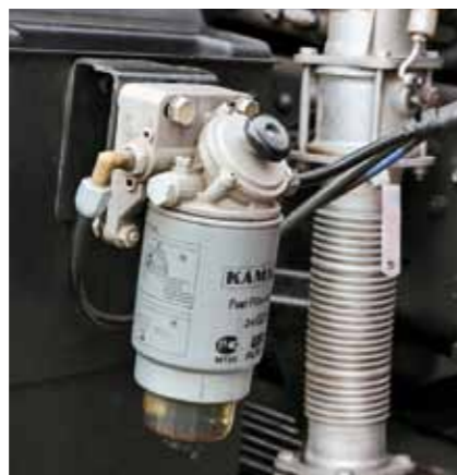
Топливный фильтр-сепаратор сэкономит топливную аппаратуру
