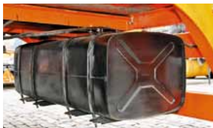
Стальной бак подвешен на четырех мощных ленточных хомутах
