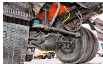
Задний мост имеет мощный стабилизатор поперечной устойчивости
