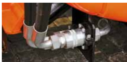
Гидроаппаратура выполнена из коррозионностойких сплавов
