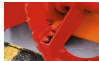
Рабочие элементы ротора крепятся мощными болтами
