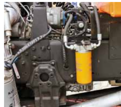
Заменить фильтр гидравлической системы – пара пустяков
