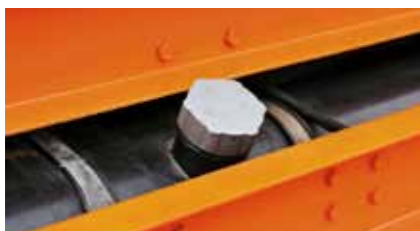
Топливный бак шасси закрыт мощным стальным отбойником
