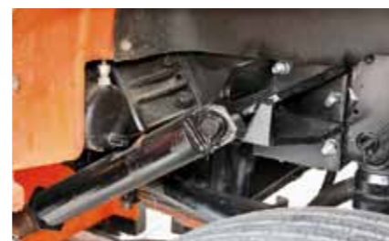
Кронштейны закреплены на раме шасси мощными болтами
