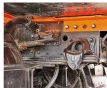
Задняя подвеска имеет как основную рессору, так и подрессорник
