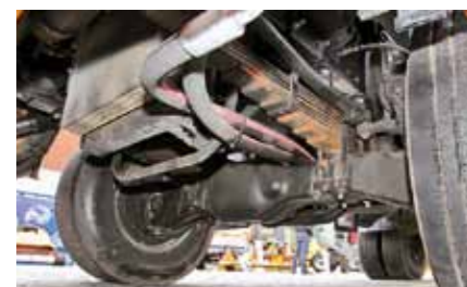
Передняя подвеска шасси на надежных многорычковых рессорах
