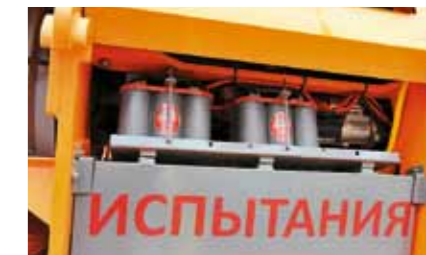
Две аккумуляторные батареи рулонного типа питают стартер установки
