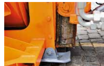
Шнекоротор опирается на поверхность дороги мощными лапами
