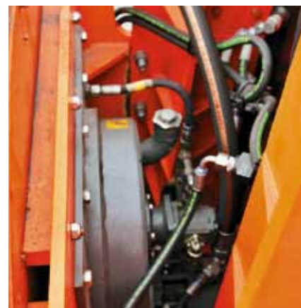
Привод ротора снегоочистителя – мощным гидромотором
