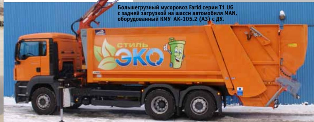
Большегрузный мусоровоз Farid серии T1 UG с задней загрузкой на шасси автомобиля MAN, оборудованный КМУ АК-105.2 (А3) с ДУ.
