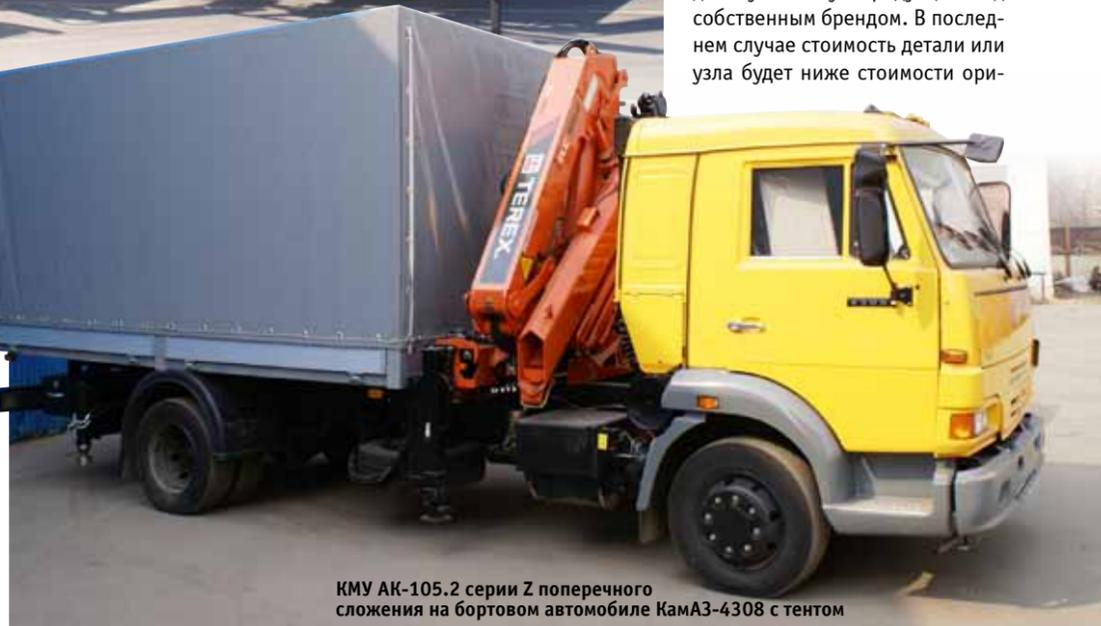
КМУ АК-105.2 серии Z поперечного сложения на бортовом автомобиле КамАЗ-4308 с тентом
