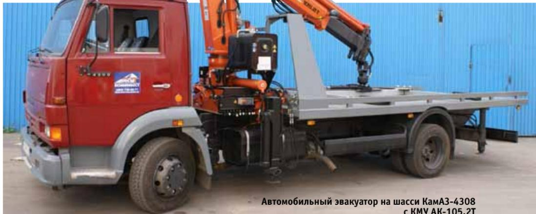
Автомобильный эвакуатор на шасси КамАЗ-4308 с КМУ АК-105.2Т
