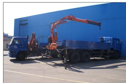
вание кран-манипуляторов выполнено, в зависимости от модели, в виде сварной или литой конструкции. Основание и колонна крана особенно усилены в местах, подверженных наибольшему напряжению, поэтому весь механизм долгое время может подвергаться большим стрессовым нагрузкам без разрушения и потери рабочих качеств. При всем этом конструкция имеет хорошее соотношение между весовыми и эксплуатационными характеристиками.
