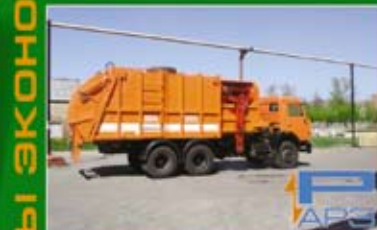
ТРАДИЦИОННЫЙ МУСОРОВОЗ С БОКОВОЙ ЗАГРУЗКОЙ + ДЛЯ КОНТЕЙНЕРОВ ПЛАСТИКОВЫХ 0,12 – 1,1М3, СТАНДАРТНЫХ 0,75 М3 И 0,9М3 – ОЦИНКОВАННЫХ 0,77 – 1,1М3 + МУСОРОВОЗ МОЖЕТ КОМПЛЕКТОВАТЬСЯ КРАНОМ МАНИПУЛЯТОРОМ.
