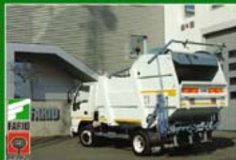
КОМПАКТНЫЕ МИНИМУСОРОВОЗЫ MICRO, MINIMATIC, MINIRACK. Емкость кузова от 3 до 10 куб. м. + возможность перегрузки в другой мусоровоз.
