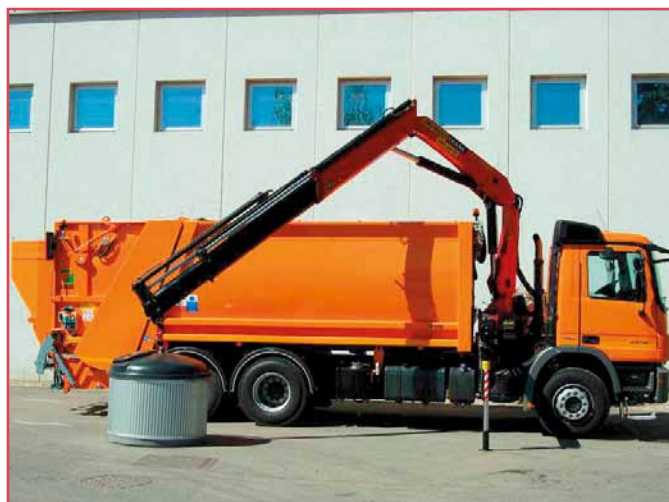
Большегрузный мусоровоз серии UG с манипулятором для заглубленных контейнеров
