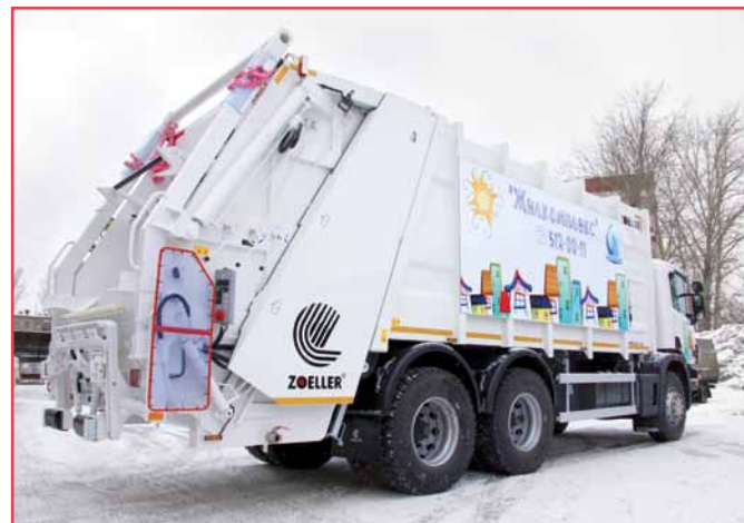
Мусоровоз Zoeller Medium XXL с подъемным устройством SK200+Welaki
