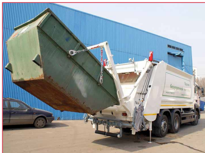
Мусоровоз с порталным подъемником для контейнеров-лодочек
