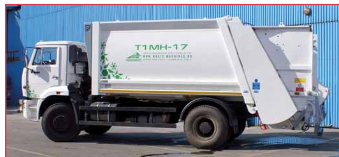
Мусоровоз FARID с объемом кузова 17 м 3 на шасси КАМАЗ 53605
