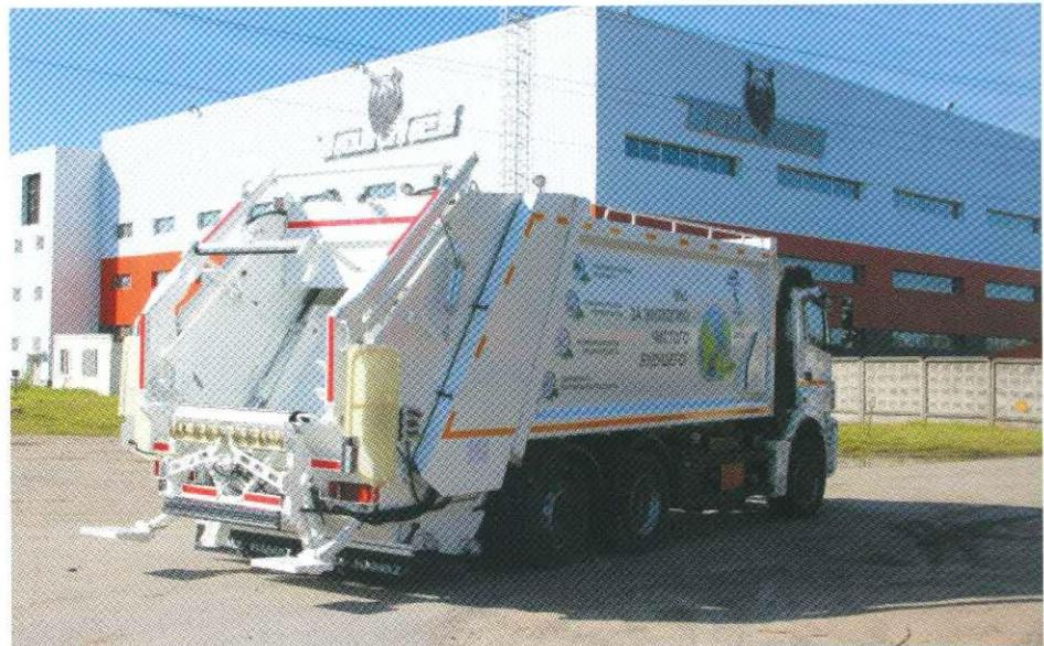
Рис. 2. Мусоровоз с объемом кузова 18–22 т
