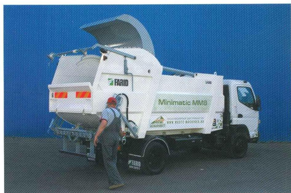
Рис. 3. Мусоровоз с объемом кузова 8,5 т
