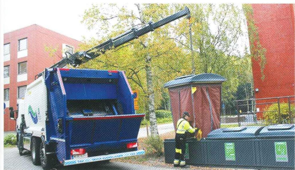
Рис. 7. Мусоровоз с краноманипуляторной установкой
