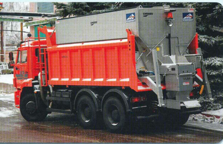
осуществляется посредством применения специальной коробки отбора мощности без использования карданныго вала, что существенно повышает надежность и КПД гидропривода. Навесные агрегаты подключаются к гидросистеме машины при помощи быстроразъемных соединений (БРС). Управление оборудованием осуществляется из кабины, а также при помощи дополнительного выносного пульта управления.
