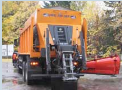
КДМ на базе шасси Volvo: в кузов установлен распределитель ПГМ марки Ероке (Дания)
