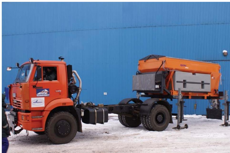
материалов – 9 куб. м, плюс два бака для увлажнения по 1,5 куб. м. Все емкости снабжаются датчиками опорожнения. Параметры распределения материала регулируются из кабины в зависимости от требуемой плотности обработки.
