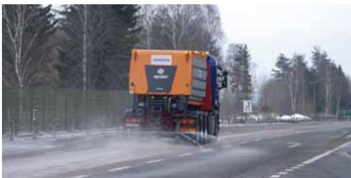
кузовом, трехсторонней разгрузкой, вместимостью 15 м<sup>3</sup>. В зимнее время в самосвальный кузов устанавливается оборудование для распределения противогололедных материалов (ПГМ) Epoke Sirius AST SE3800 (9м3). Комплектация предусматривает два бака для увлажнения общим объемом 3076 л. Параметры расходования материала регулируются с помощью современной беспроводной системы управления EроMaster IV. При изменении рабочей скорости КДМ,
